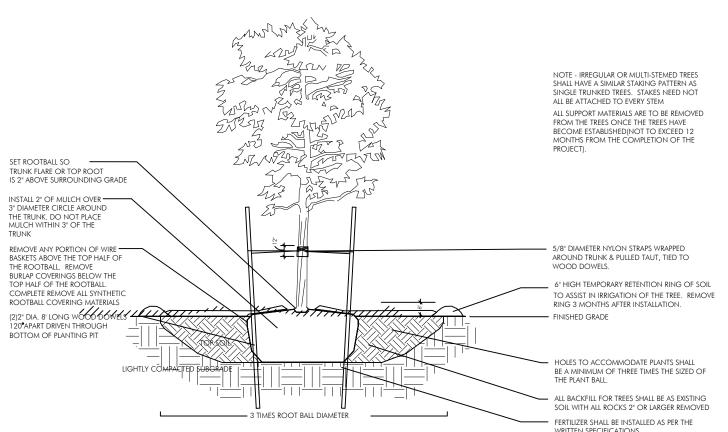
PLANTING & BRACING DETAIL UNDER 3 1/2" CALIPER
