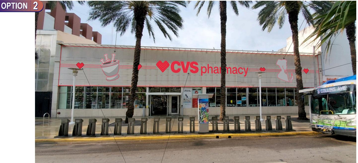
FRONT: RED LED GE TETRA CONTOUR TUBE TO PULSE; HALO: WHITE ILLUMINATION STATIC.
